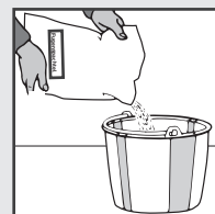
Rysunek 10: masę szpachlową do spoin fermacell wsypać do wody
