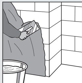
Rysunek 18: na ścianach kominowych warstwa kleju nanoszona jest na całość powierzchni, potem przykleja się płytę fermacell
