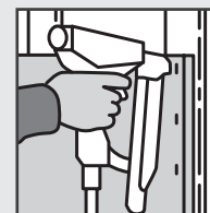
Rysunek 6: mocowanie płyt klamrami do drewnianej konstrukcji nośnej
