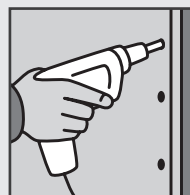
Rysunek 5: mocowanie płyt wkrętami do stalowej konstrukcji nośnej
