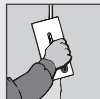
Rysunek 11: zaszpachlować spoiny i elementy mocujące
