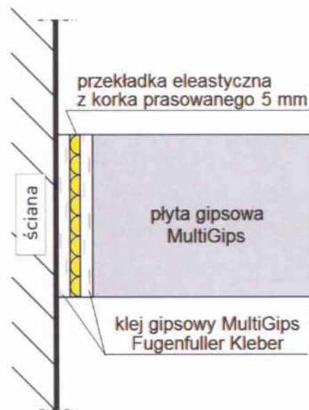
Rys. 2. Schemat połączenia ściany z płyt gipsowych ze ścianami sąsiednimi.
